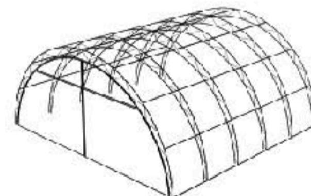
Plastenik Salat Centar tip VI se može praviti sa ravnim bočnim stranama, po želji i bočnim otvaranjem ručno ili na elektromotor, gde je to moguće. Ako je namena plastenika da služi kao magacin, onda se prave četvorodelna vrata koja omogućavaju ulazak kamiona ili šlepera.
